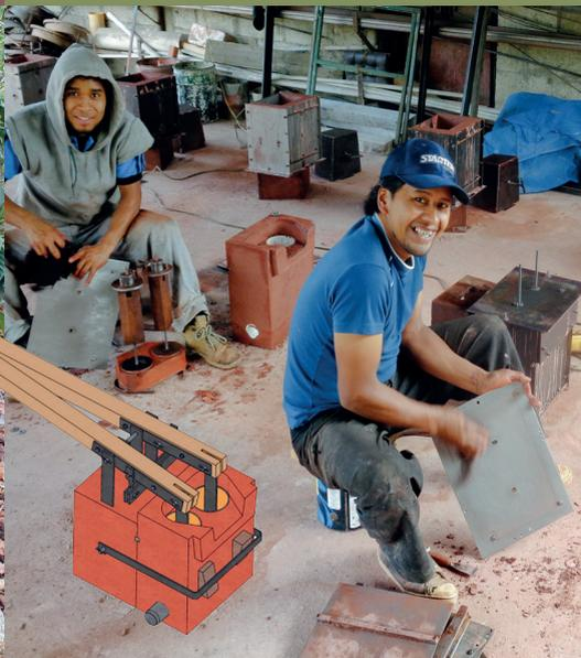
La pompa a pedali swiss-PEP è il cuore dei sistemi di irrigazione su piccola scala di Aqua Alimenta. Tiene conto dei bisogni e delle possibilità delle famiglie di piccoli coltivatori. Sviluppata da ingegneri svizzeri, prodotta in loco, potente, durevole, di facile manutenzione, funziona senza emissioni di CO<sub>2</sub>.
